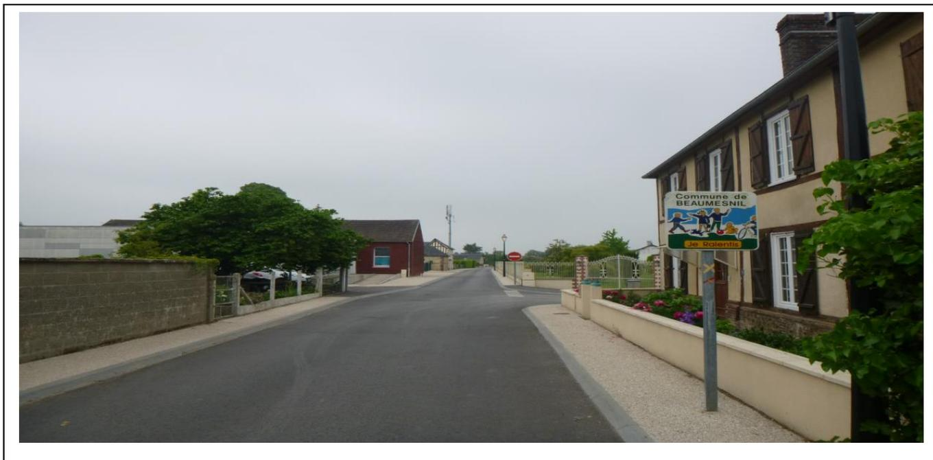
Chaussée en enrobé – Trottoirs en béton désactivé – Bordures en béton
