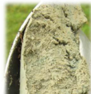
Photo d'un sondage à la tarière permettant de caractériser une zone humide
