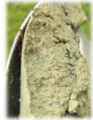
Photo d'un sondage à la tarière permettant de caractériser une zone humide
